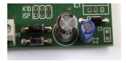
14.) Assemble capacitor C3
